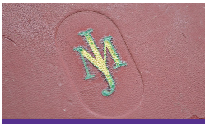
Obr. 18 Vznik měděnky na ražbě s mosaznou fólií. Autor H. Sharai
