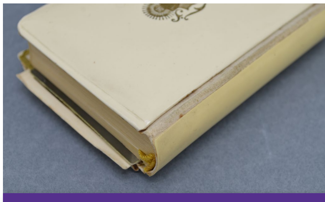
Obr. 13 Zežloutnutí hřbetu z nitrátu celulózy způsobená vlivem světla. Autor H. Sharai
