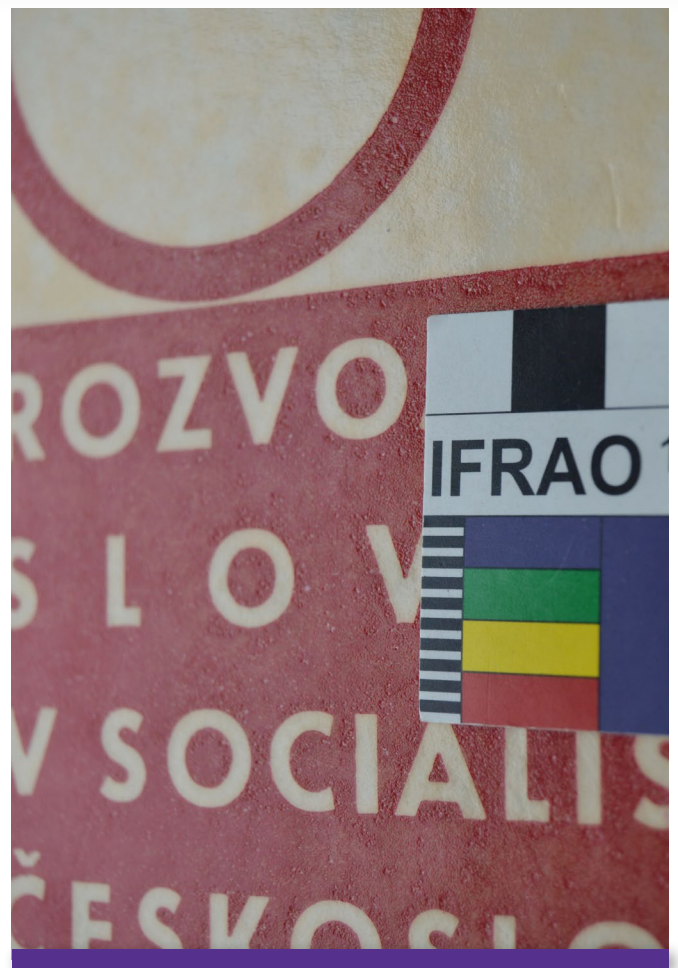
Obr. 7 Póry v PVC-P laminaci – defekt způsoben výrobou. Autor T. Imrich
