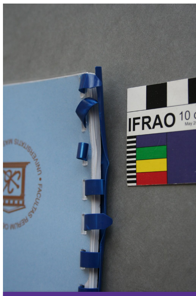
Obr. 11 Ukázka mechanického poškození PVC-U způsobeného špatným uložením a nešetrnou manipulací. Autor T. Imrich
